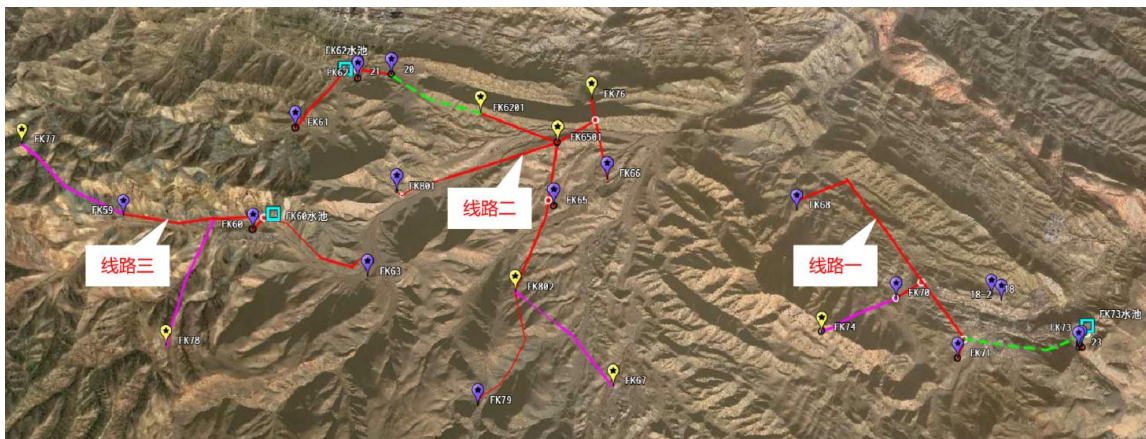
图3.3-1 新建排水管线走向示意图
